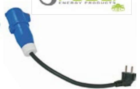
Adattatori 16A 40cm cavo: H07RN-F3G 1.5mmq 230V AC Adaptor 16A 230V AC Cable: H07RN-F3G 1.5mmq - 40cm long
