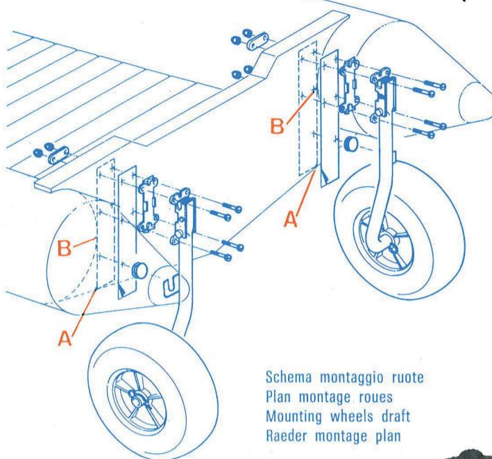
Schema montaggio ruote
